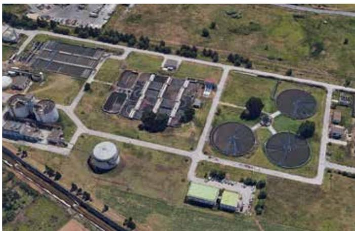
La Regione ha programmato la realizzazione di due interventi all'impianto di depurazione di Mercato San Severino. Il primo ottimizzerà i processi produttivi, con la realizzazione di una centrifuga e di un silos di stoccaggio dei fanghi di depurazione. Il secondo prevede l'adeguamento del sistema di controllo delle emissioni in atmosfera provenienti dall'impianto. I due interventi prevedono una spesa di circa 5 milioni di euro.
