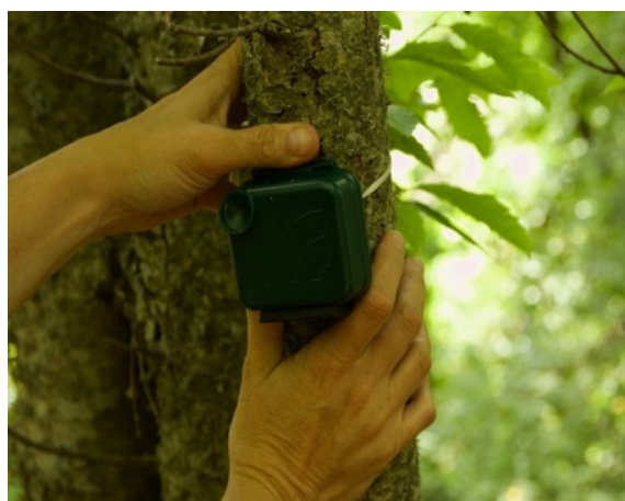
Figura 12 - Rilievi notturni con bat detector su punti di ascolto e car transect . In basso strumentazione utilizzata.
