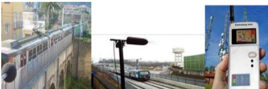
**Figura 19** – Fonometri e misuratori di campi elettromagnetici per il monitoraggio dell'impatto ambientale del sistema ferroviario.
