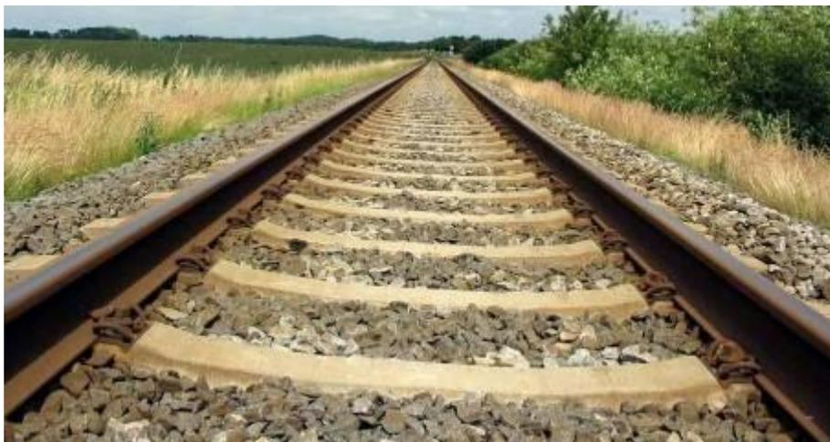
**Figura 4** – *Ballast e traversine ferroviarie.*
