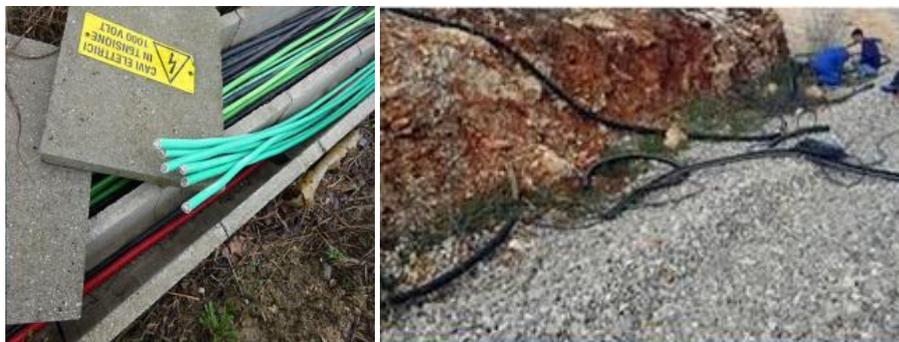
**Figura 13** – Esempi di guasto sulla linea ferroviaria: sabotaggi per furto rame.
