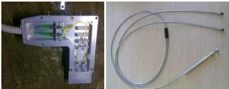
**Figura 22** – Sensori in fibra ottica per la rilevazione di GPL e di radiazione-
