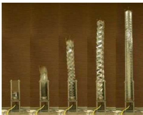
**Figura 10** – Esempio di struttura deployable, estensione di un montante di supporto (Fonte Università di Bristol).
