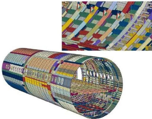
**Figura 4** – Modello strutturale di una fusoliera [175].
