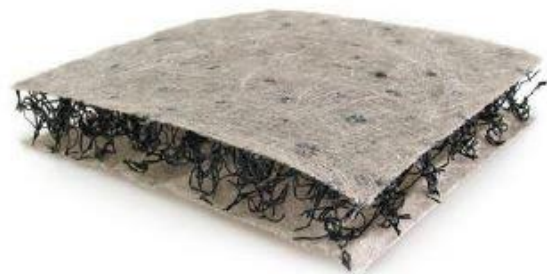
Posa in opera del geocomposito e particolare degli elementi costitutivi
